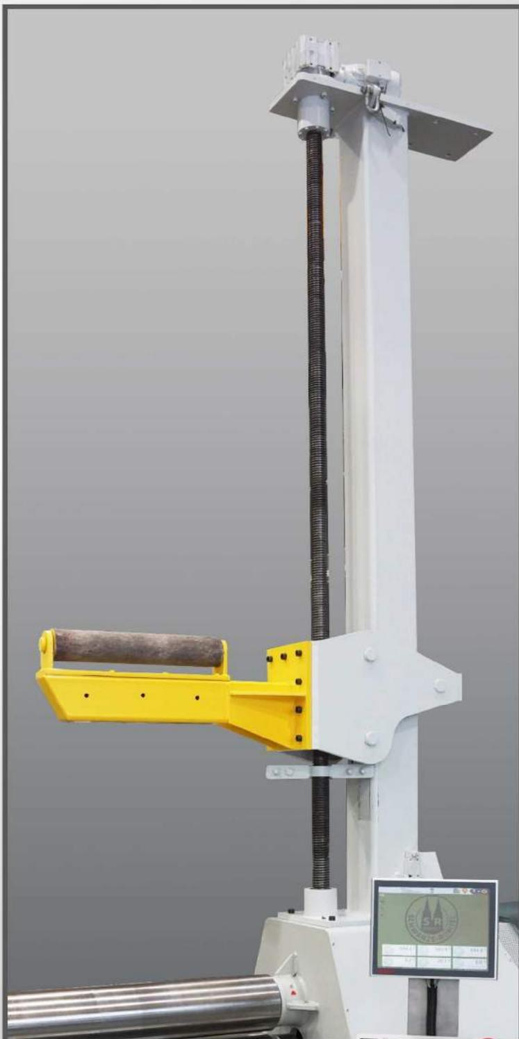
Support électromécanique sur un PB3-8-4. Naturellement, vous pouvez également obtenir un support supérieur avec un fonctionnement hydraulique au besoin
