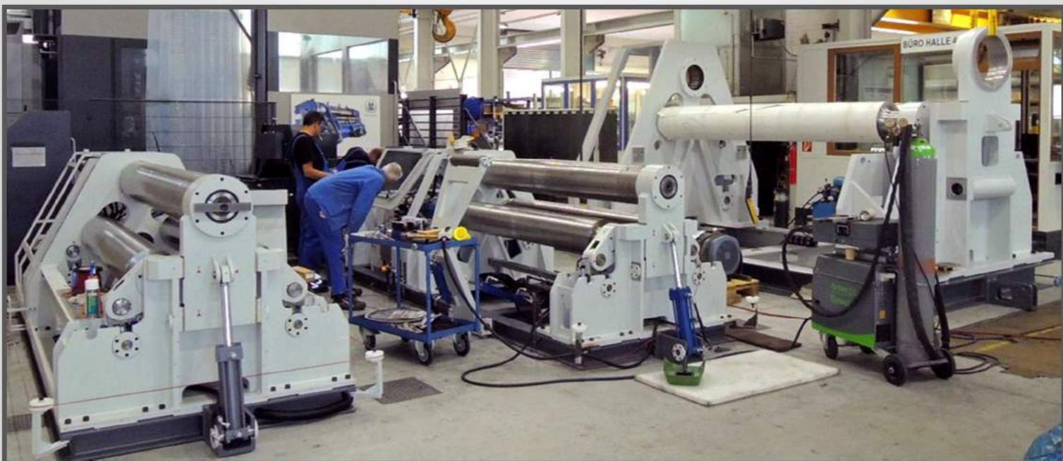
Assemblage de trois plieuses à plat, deux du modèle PB3-12-6 et une PB3-18-106
