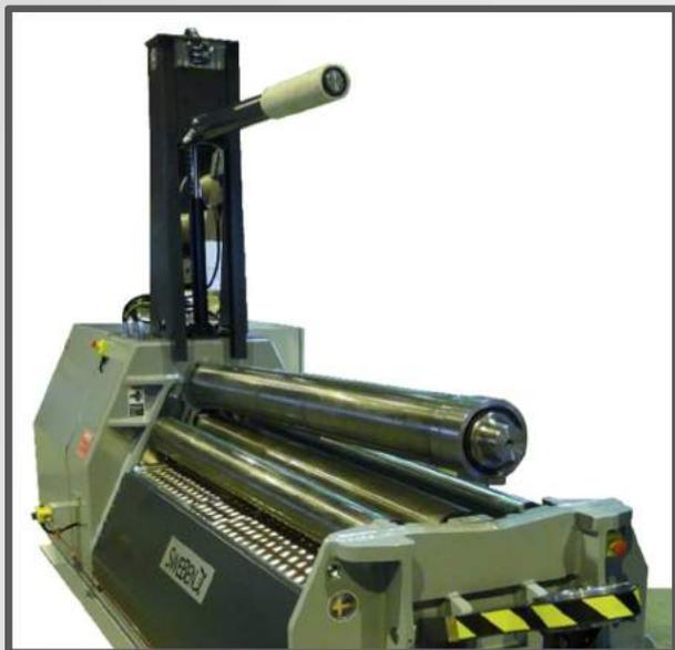
*PB4-8-6 avec rouleau de levage hydraulique en position la plus haute*
