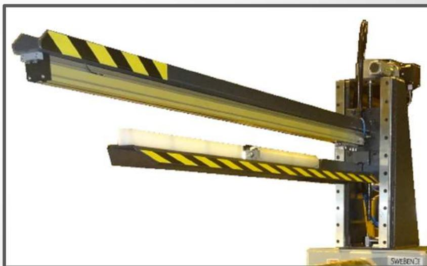
*Rouleau de levage électro-mécanique avec dispositif d'éjection*
