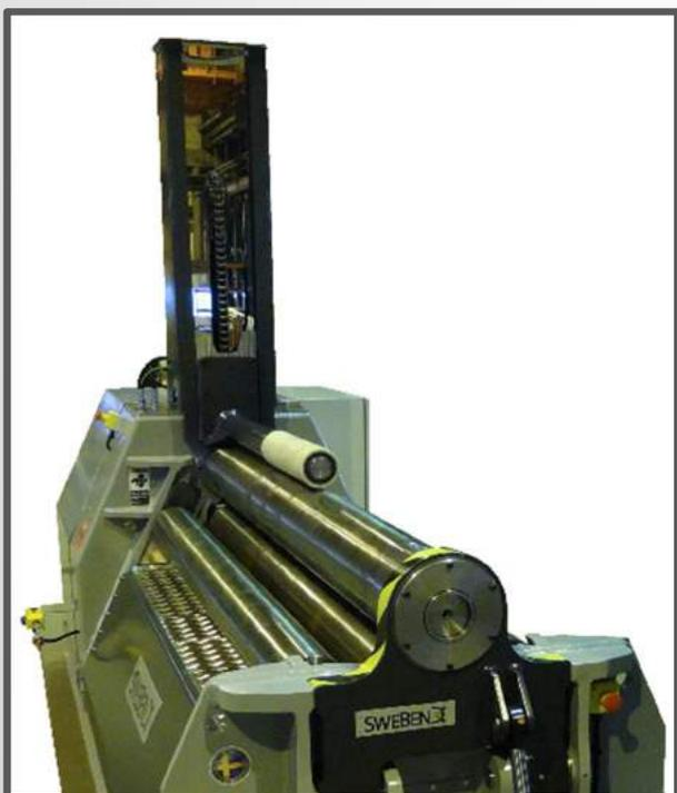
*PB4-8-6 avec rouleau de levage hydraulique en position basse*
