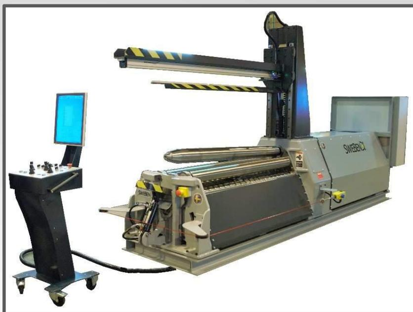
*PB4-4-4 CNC avec kit turbo haute vitesse, barre de levage hydraulique spéciale et dispositif d'éjection pour des diamètres extrêmement petits*
