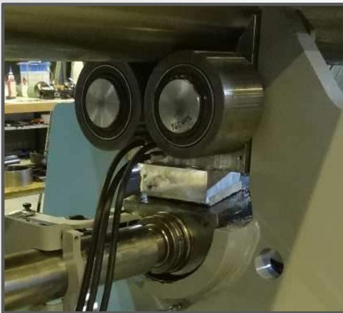
Rouleaux de support motorisés (équipement optionnel) sous le rouleau inférieur pour "ajuster" le roulement des rouleaux et compenser la déflexion du rouleau.
