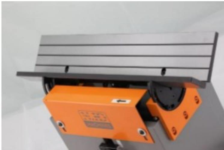
Avant de démarrer la machine, assurez-vous que la tête de coupe tourne librement et qu'elle ne touche pas le bas des guidage. A chaque changement d'angle, la distance entre la tête de fraisage et les guidage est également modifiée.
